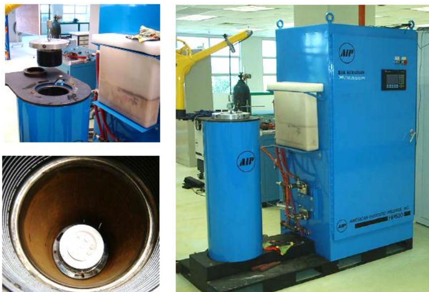
Рисунок 4 Пресс горячего изостатического прессования AIP6-30H
