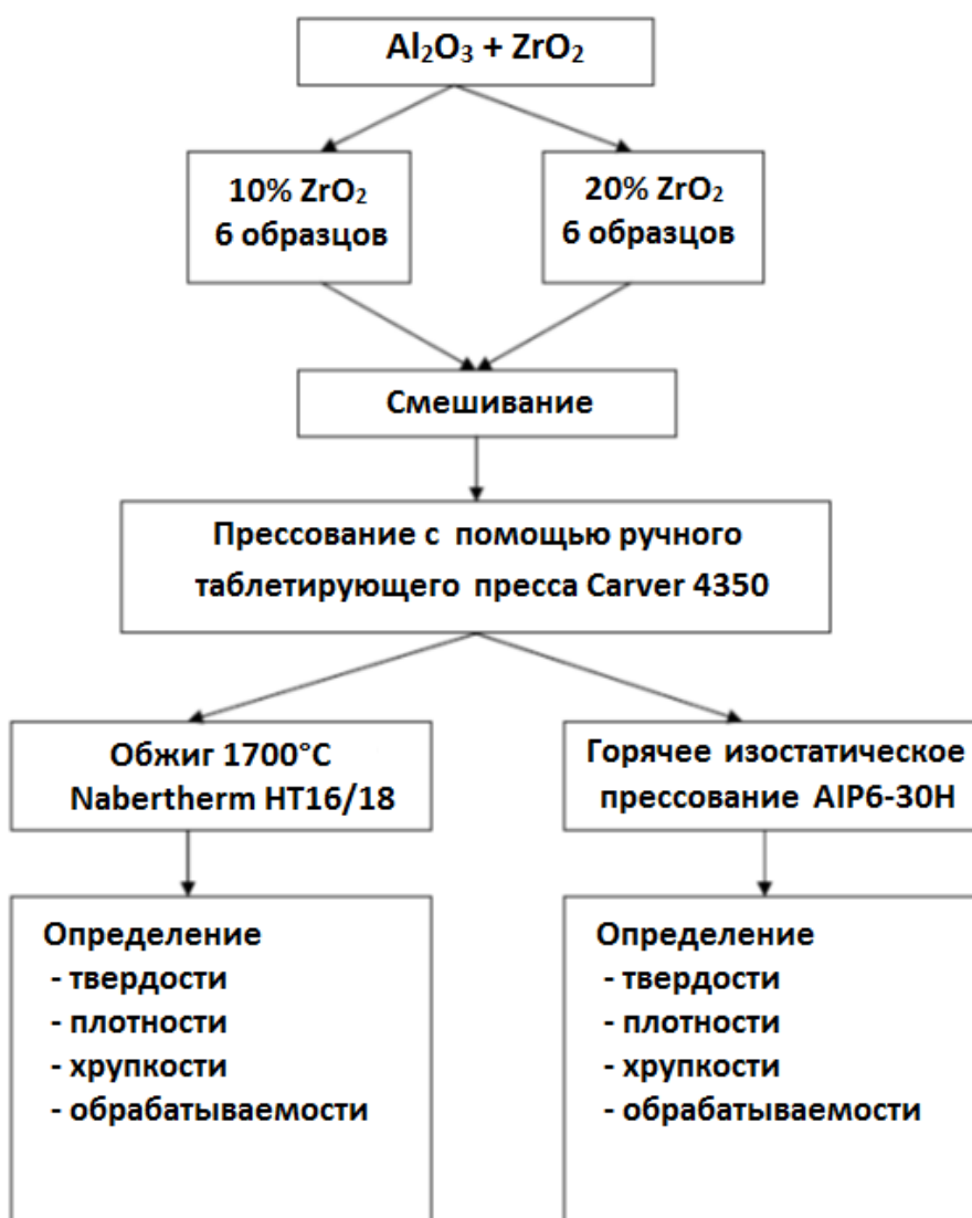
Рис.1 Технологическая схема получения керамики Al_2O_3 + ZrO_2
