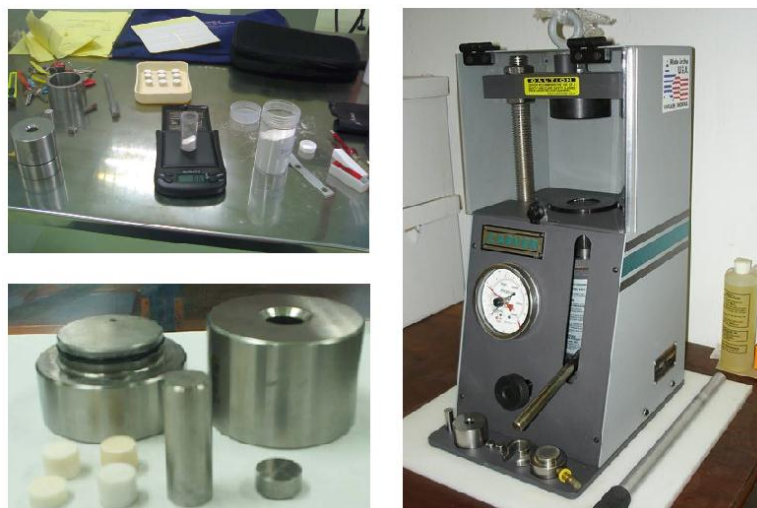
Рисунок 2 Пробоподготовка образцов при помощи прессы Carver 4350
